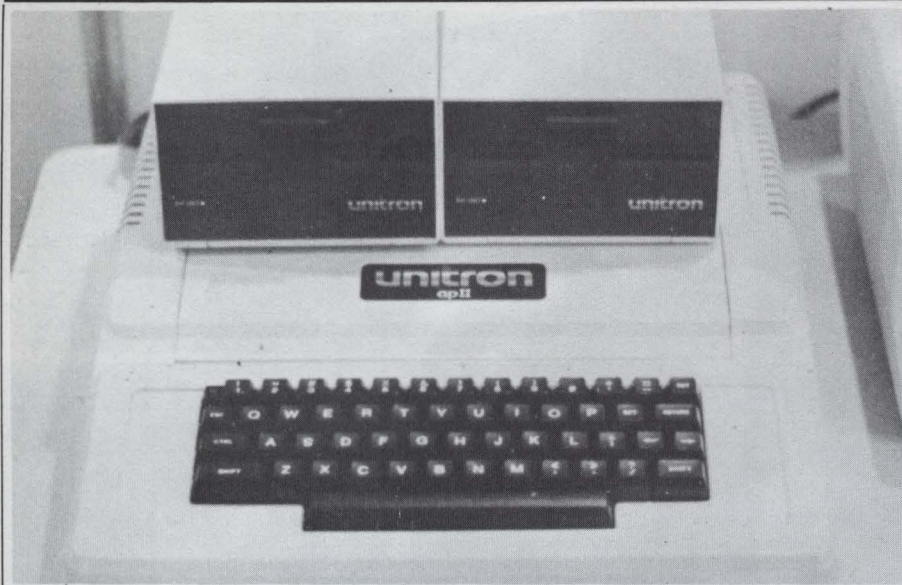
O AP-II da Unitron tem oito slots para expansões
